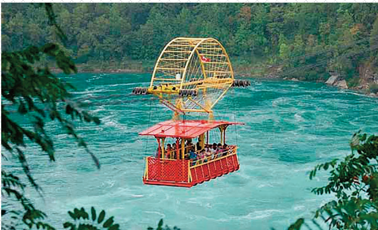
Spanish Aerocar, funicular sobre el río Niágara, a la altura de las cataratas, creado por Torres Quevedo y que aún sigue en funcionamiento con las reformas correspondientes.
